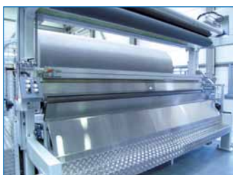
2-Stellen Abwickelmaschine der Fa. Somatec mit automatischer Ultraschall-Bahnverbindung
