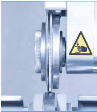
Kantenbesäumer für schmale, dünne Materialbahnen
