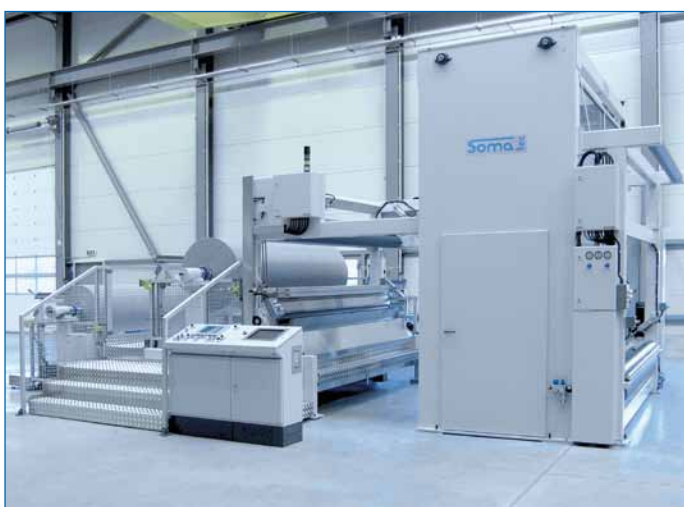
2-Stellen Abwickelmaschine der Fa. Somatec mit automatischer Ultraschall-Bahnverbindung
